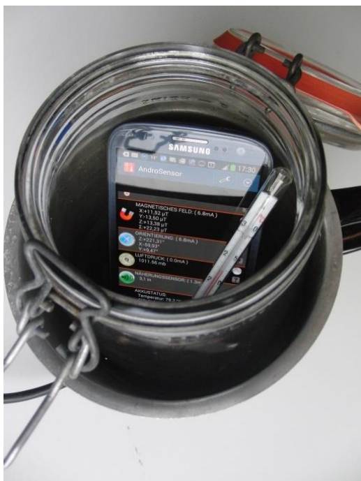
Abbildung 1: Smartphone erfasst Zusammenhang von Druck und Temperatur eines Gases.
