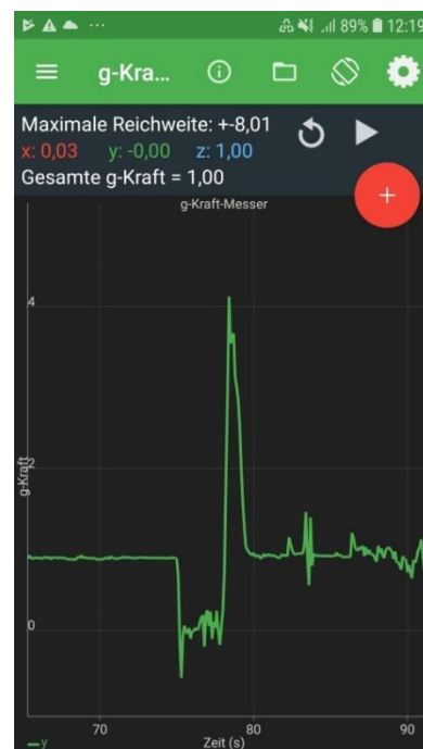
Abbildung 2: Smartphone erfasste vertikale Beschleunigung beim Fallen im Freifallturm: Querachse: Zeit in s. Hochachse: Beschleunigungsanzeige in g = 9,81 \text{ m/s}^2 . Anfangs: 1 g durch Schwerkraft. Dann 0 g während Schwerelosigkeit beim Fallen. Danach 4 g beim Abbremsen.
